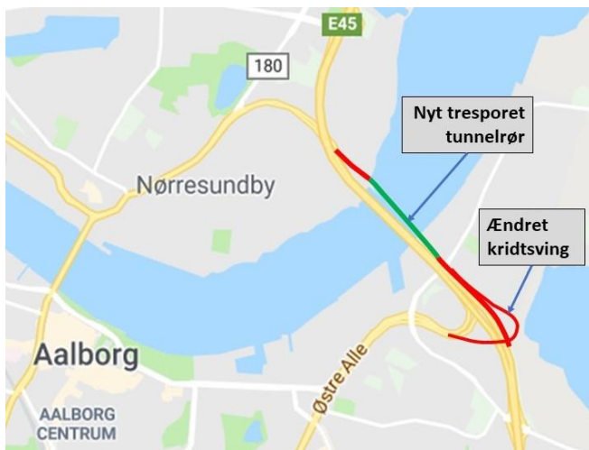
Figur 3 - Ekstra tunnelrør og Kridtsvinget
